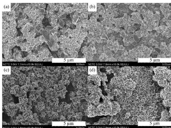
**Figure 6:** Surface morphologies of CZTS films (a) 200°C, (b) 300°C, (c) 400°C and (d) 500°C.
